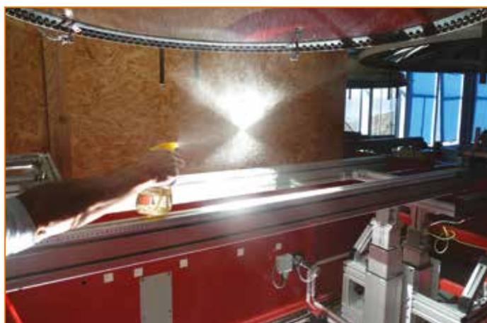
Photo 2. Un concentrateur de 1,5 kW pour une tache focale de diamètre centimétrique permet de produire de hautes températures. Photo Serge Rambal.
